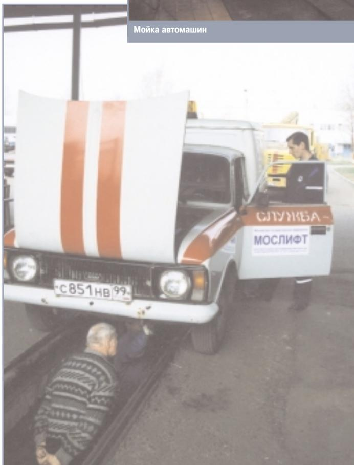
Проверка техсостояния автомобилей перед выездом на линию
